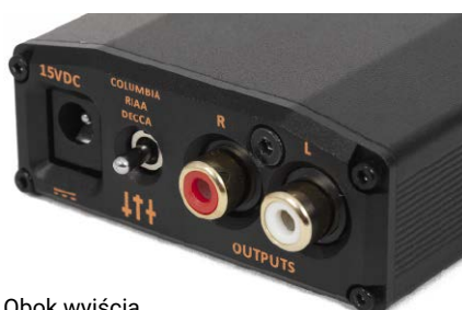
Obok wyjścia umieszczono przełącznik krzywych korekcyjnych.
